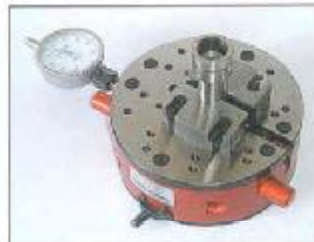
Messung kleiner tiefer Bohrungen, Auflage auf Tisch CTR 5-160*
