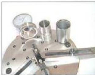
2-Punkt-Messung kleiner Bohrungen mit Zentrierpunkt*
