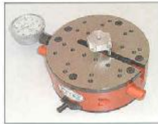
Messung von Bohrungsabständen
