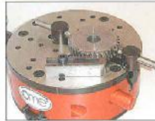
Messung des Ma-Masses an Aussenverzahnungen* (2 Kugellaster)
