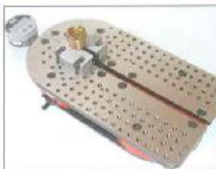
Kleine Bohrung und Inneneinstich, Auflage auf Tisch CTR 5-160*
