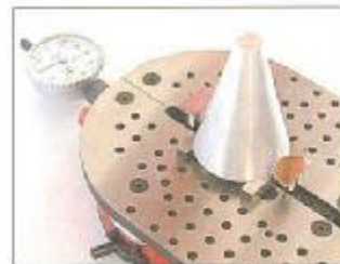
Messung des Durchmessers an Aussenkegel, Messhöhe mit Endmassen definiert
