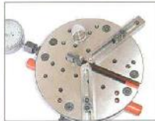
3-Punkt-Messung von Bohrungen* (1 beweglicher und 2 Festpunkte)
