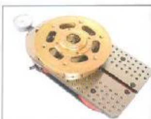
Messung kurzer Ansätze an einem Flansch
