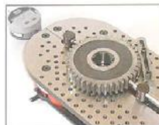
Messung des Ma-Masses an Aussenverzahnungen
