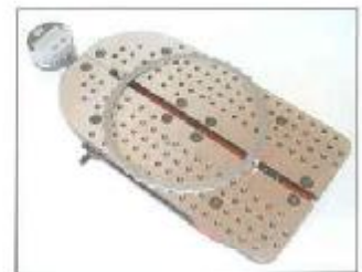
Messung des Durchmessers an Aussentaschen
